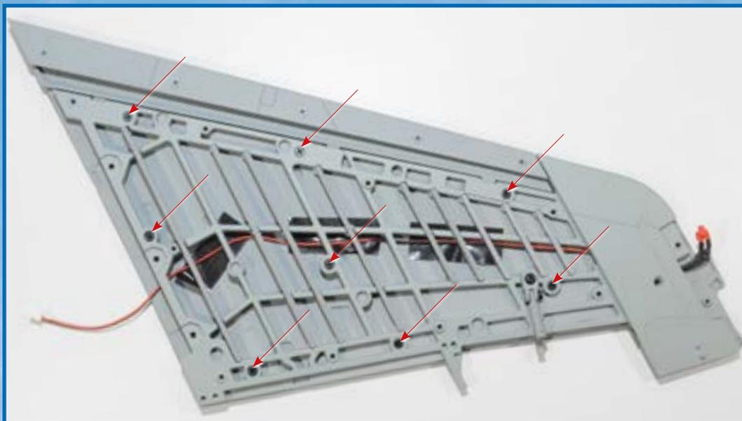
**6** Зафиксируйте обшивку крыла винтами NP в местах, указанных на снимке.
