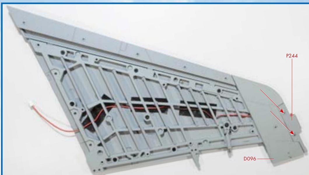
**8** Установите нижнюю часть законцовки крыла (P244), как показано на снимке, и зафиксируйте деталь винтами SM.
